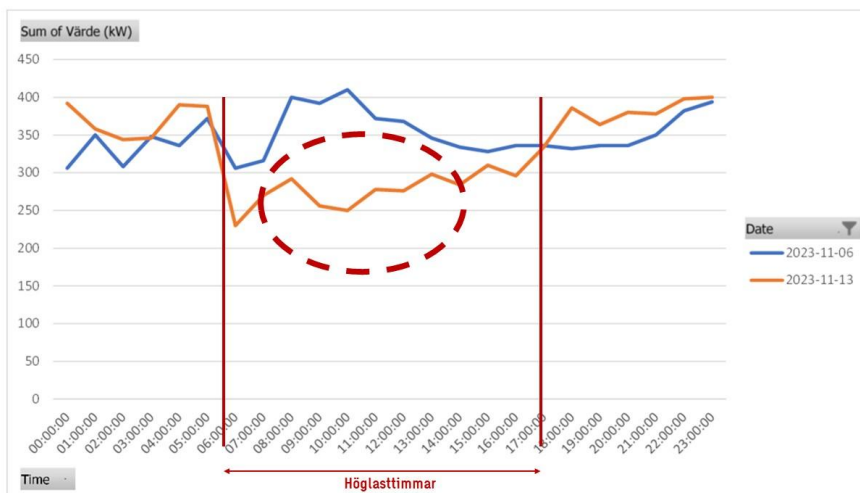
Figur 6 - Grafen visar ett exempel för hur förbrukningsmönstret i kylanläggningen såg ut innan kontra efter en förändring som genomfördes inom pilotstudien 2023. Där den blå linjen är innan, och den orangea linjen är efter förändringen. En dataanalys under pilotsäsongen 2023–2024 definierade därefter referens- och maxvärde för MaxUsage.
